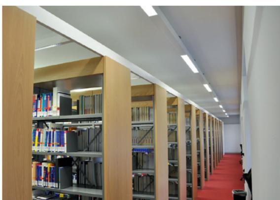
Die beiden Lesesäle im 1. und 2. Obergeschoss mit einer Fläche von 476 m<sup>2</sup> und 491 m<sup>2</sup> werden von den Stirnseiten und von der Mitte aus mit Zuluft versorgt. Die Auslassöffnungen sind bis 30 m voneinander entfernt. Zu- und Abluftöffnungen liegen teilweise nur 2 m auseinander. Bevor die Luft in den Raum eintritt, wird sie im Deckenplenium und in den Vorwandinstallationen entspannt.
